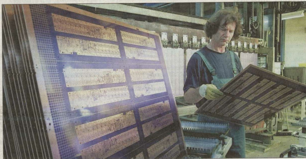
Michael Günther in der Galvanik der Leiterplattenfertigung der KSG in Gornsdorf.
